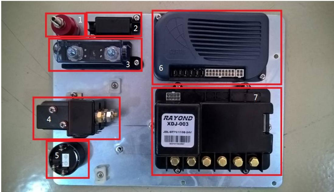
1. 接线柱.所有电路的负极,与电瓶负极相连.
